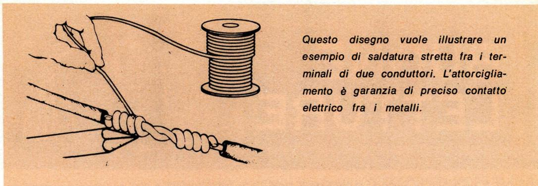
Questo disegno vuole illustrare un esempio di saldatura stretta fra i terminali di due conduttori. L'attorcigliamento è garanzia di preciso contatto elettrico fra i metalli.
